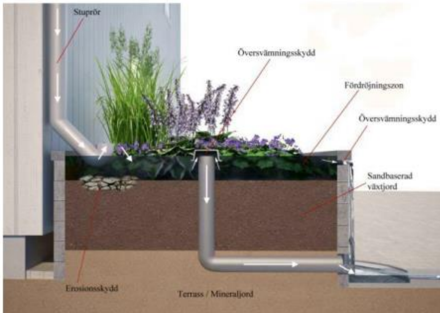
Figur 4. Principskiss upphöjd växtbädd. (Bildkälla: Grågröna systemlösningar för hållbara städer, Inventering av dagvattenlösningar för urbana miljöer, Vinnova 2014.)
