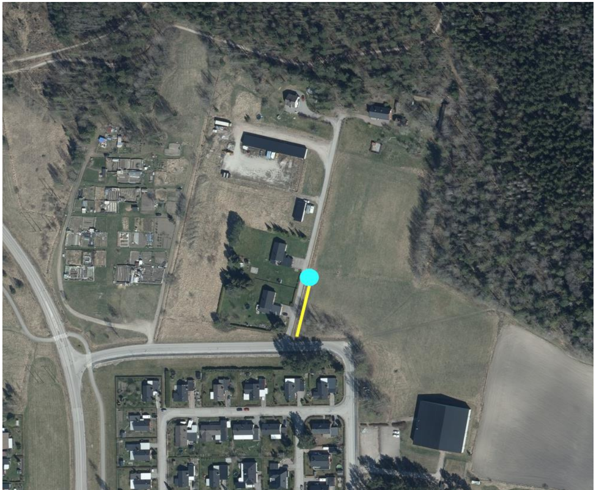
Figur 6.1. Lågpunkt med risk för vattensamling markerat med ljusblått.
