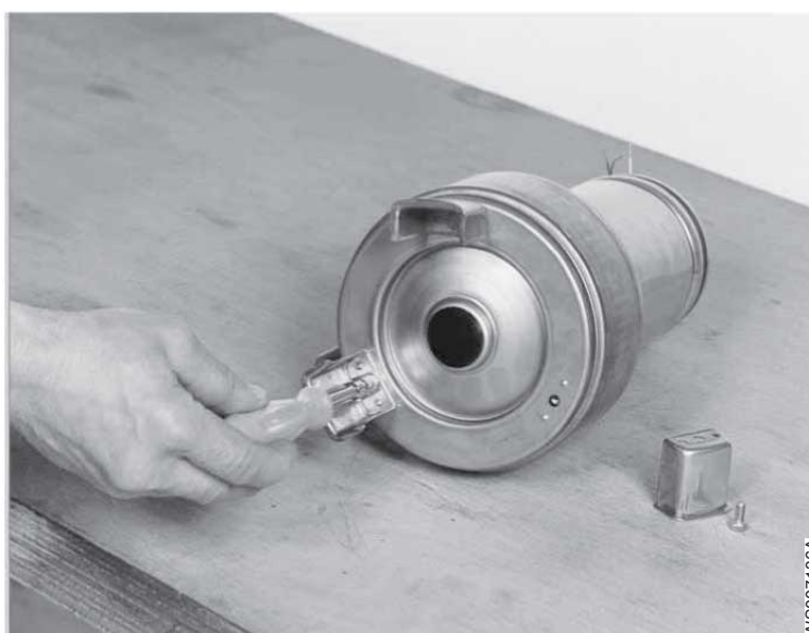
Figur 10: Avlägsnande av pumpfötter
