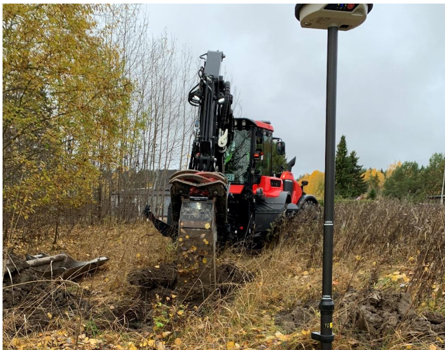
Figur 4: Jordprovtagning genom provgrovsgrävning med grävmaskin. Källa: Tyréns
