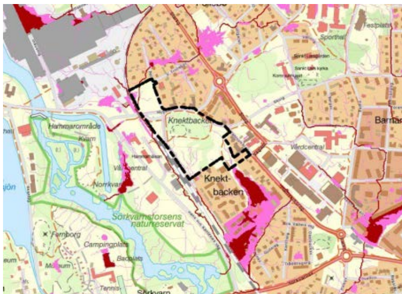
Figur 6 Skyfallskartering. Karta som visar lågpunkter där vatten kan samlas vid kraftiga regn. Rosa visar potentiellt riskområde med djup över 0,2 meter och rött visar potentiellt riskområde med djup över 1 meter. På kartan visas också större flödeslinjer i rött och mindre i rosa. Planområdet finns inom svart streckad linje. För större bild se bilaga till dagvattenutlåtandet.
