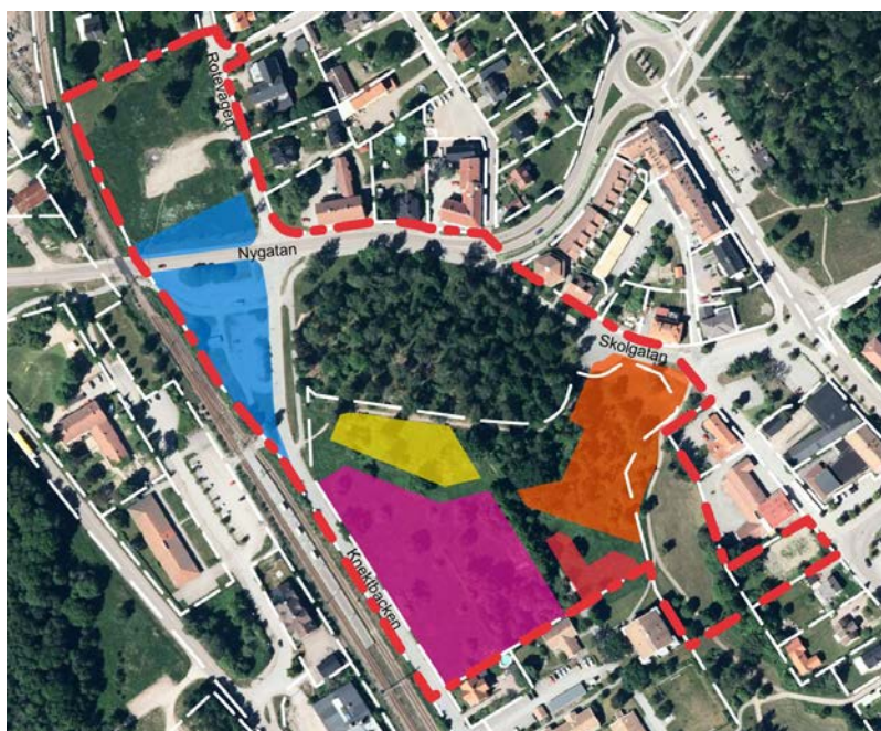
Figur 17 Nya fastigheter, minimum, i färg. All övrig mark inom planområdet föreslås tillhöra Eldsboda 1:286. Dagens fastighetsgränser redovisas med vit streckad linje.
